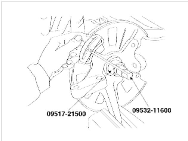
7. 如果起动扭矩为0 Nm(0 kg · cm,0 lb · ft),测量轮毂轴承轴向间隙。
