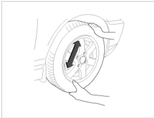
3. 如果轮胎和车轮（轮毂）在芯轴处松动,不能自由旋转或旋转时有粗糙感,则执行下列程序中的任何一个。
