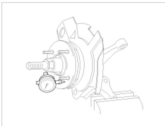
8. 如果在把螺母拧紧至200~260Nm(2000~2600 kgf · cm,145~188 lb · ft)的过程中轮毂轴向间隙超出规定值,则轴承、轮毂和转向节安装不正确,请重复分解和装配程序。
