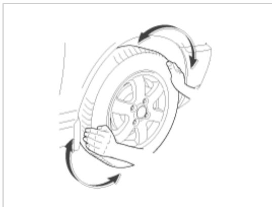
2. 紧握每个前轮胎的顶部和底部,在提升轮胎使轮胎重量脱离前车轮轴承的过程中朝内、外移动车轮。
